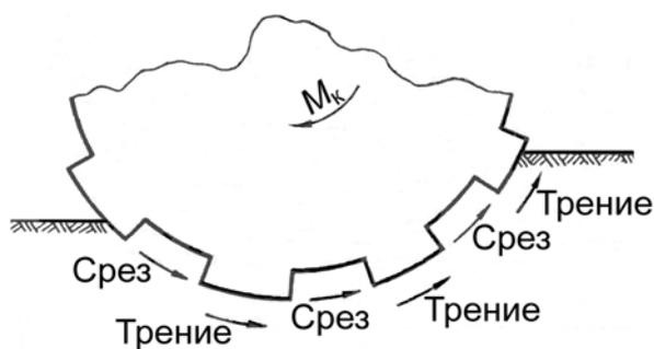
Рис. 3.15. Участки среза и трения в зоне контакта колеса с деформируемым грунтом
