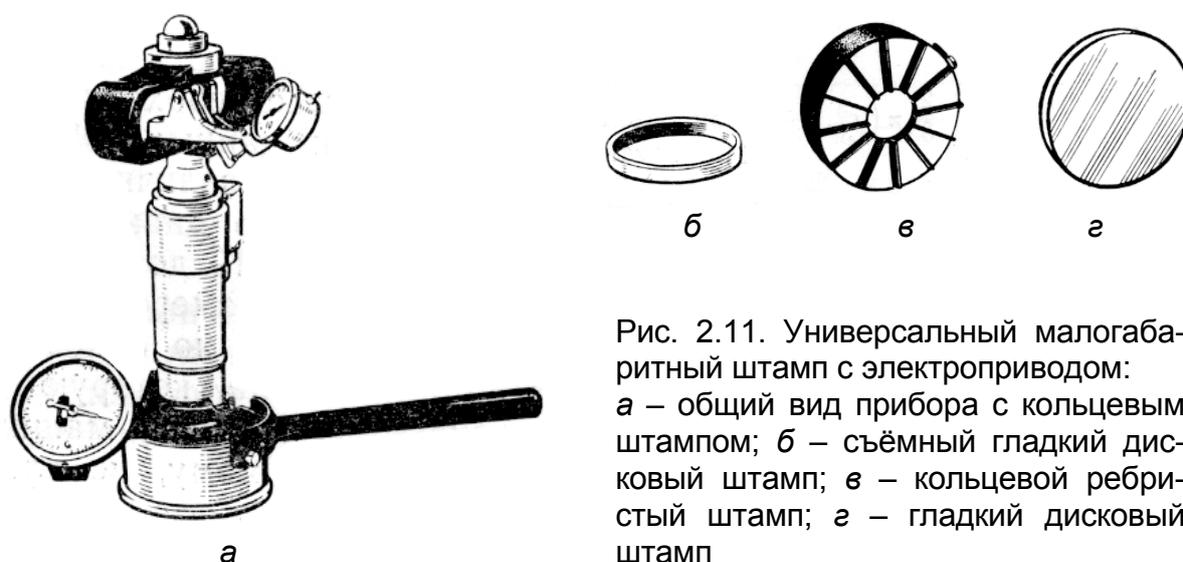
Рис. 2.11. Универсальный малогабаритный штамп с электроприводом:
